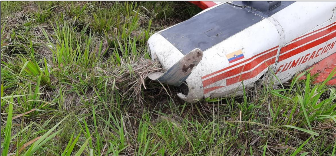
Fotografía No. 3: Detalle de la hélice y de la cubierta de la planta motriz
