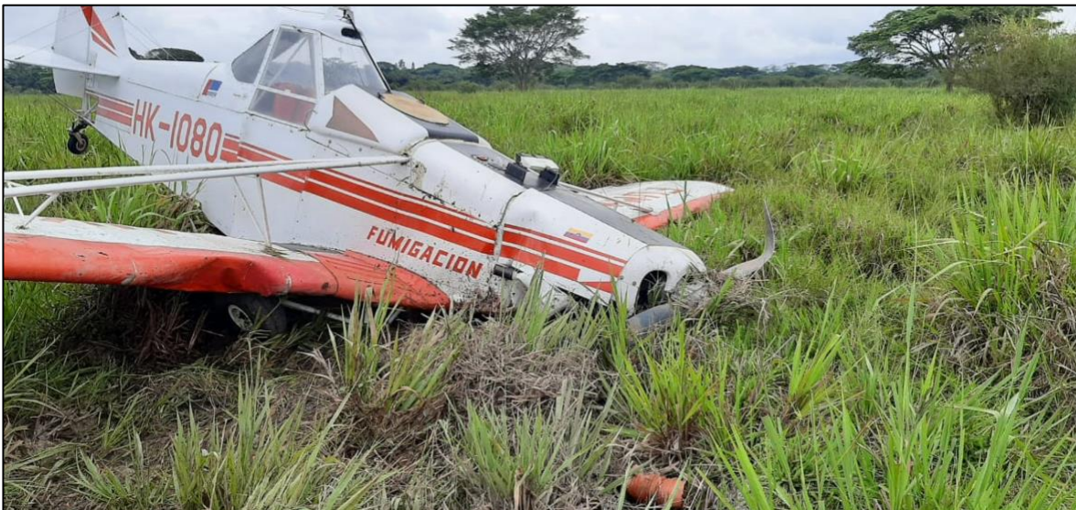
Fotografía No. 2: Detalle de daño en el plano derecho
